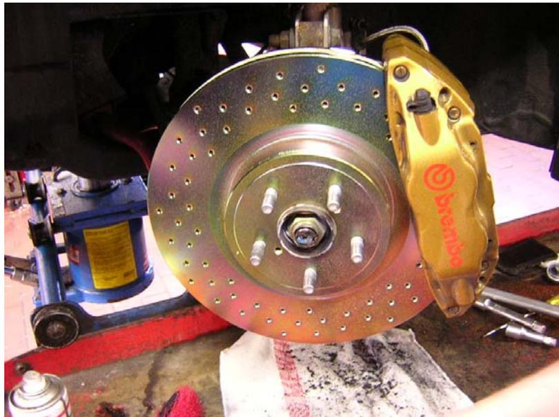
***Bremsscheibe an der Vorderachse eines Impreza***
